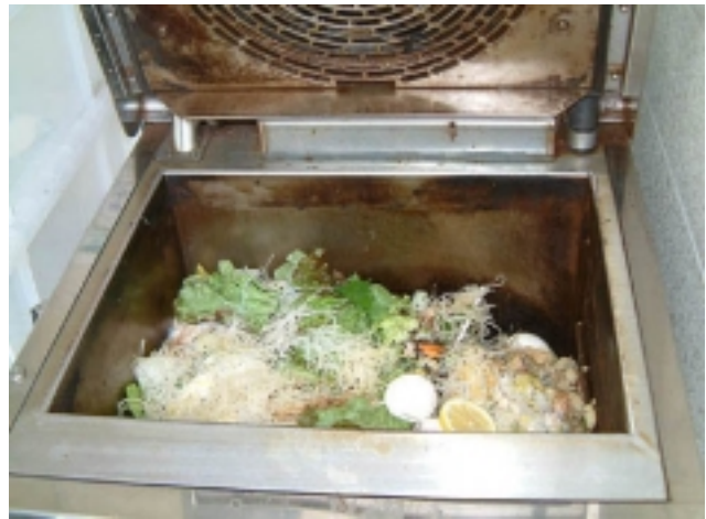
生ごみ処理機は組事務所の左スペースに設置 この処理機で乾燥したものが青森県の畑で使われている
